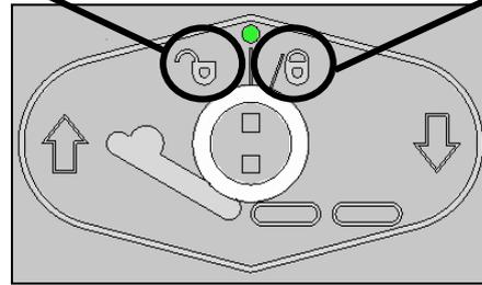
TOURNER LA CLE LEGEREMENT DANS LE SENS DES AIGUILLES D'UNE MONTRE POUR VERROUILLER LA FONCTION
